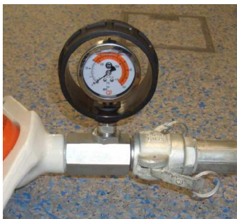
Fig. 35 : Manomètre de pression du mortier
