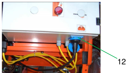
Fig. 12 : Raccords armoire de distribution
