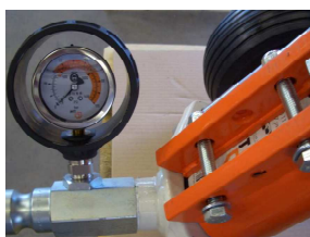
Fig. 20 : Manomètre de pression du mortier
