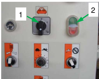
Fig. 43 : Mise en marche du compresseur d'air
