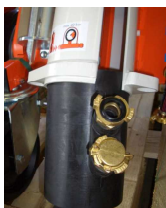
Fig. 60 : Nettoyer la zone de mélange en caoutchouc
