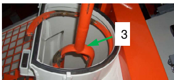
Fig. 64 : Retirer le mélangeur
