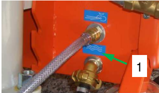
Fig. 41 : Raccorder la lance de projection
