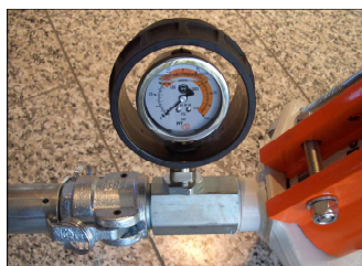
Fig. 73 : Pression du mortier égale à « 0 bar »
