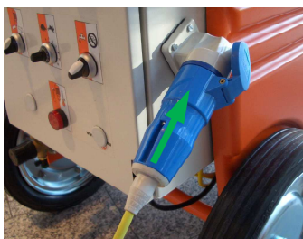
Fig. 26 : Raccordement électrique
