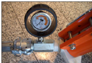
Fig. 70 : Manomètre de pression du mortier
