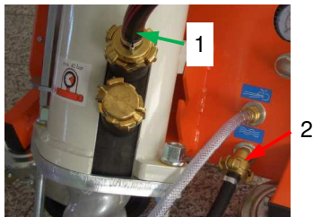
Fig. 63 : Couper l'arrivée d'eau
