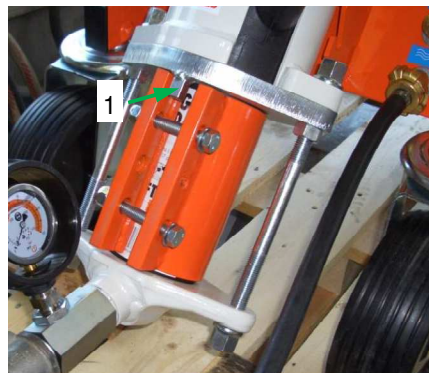
Fig. 44 : Collier de serrage
