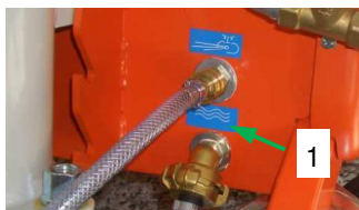
Fig. 45 : Raccorder la lance de projection
