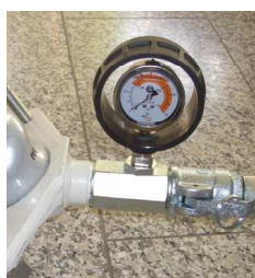
Fig. 74 : Manomètre de pression du mortier
