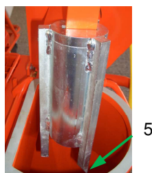
Fig. 59 : Monter le nettoyeur de la chambre de mélange
