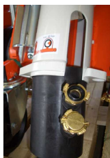
Fig. 64 : Nettoyer la zone de mélange en caoutchouc
