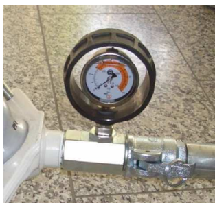
Fig. 39 : Manomètre de pression du mortier
