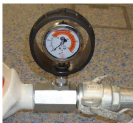
Fig. 23 : Manomètre de pression du mortier
