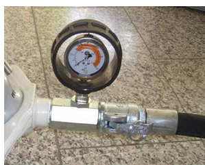
Fig. 77 : Pression du mortier égale à « 0 bar »
