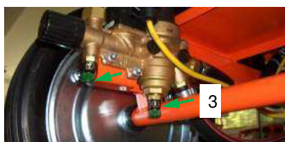
Fig. 69 : Ouvrir le robinet de drainage
