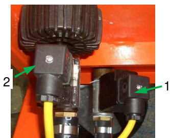
Fig. 84 : Pressostats
