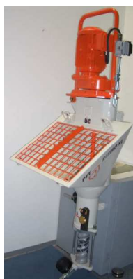
Fig. 25 : Unité de la pompe mélangeuse
