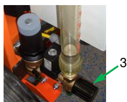
Fig. 83 : Soupape de réduction de la pression
