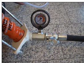
Fig. 69 : Manomètre de pression du mortier
