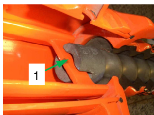
Fig. 60 : Position du rotor
