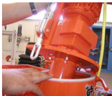
Fig. 56 : Rabattre la bride de basculement du moteur
