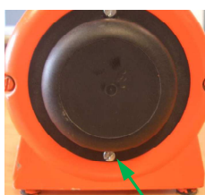
Fig. 76 : Ouverture du couvercle du filtre
