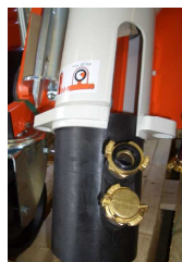
Fig. 59 : Nettoyer la zone de mélange en caoutchouc
