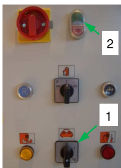
Fig. 42 : Mise en marche du compresseur d'air
