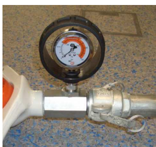
Fig. 35 : Manomètre de pression du mortier
