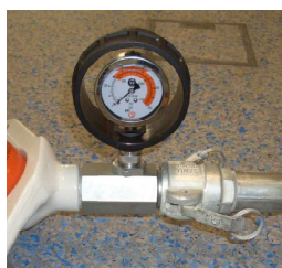
Fig. 22 : Manomètre de pression du mortier
