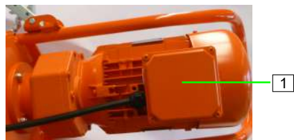
Figure 25 : Contacteur d'inclinaison
