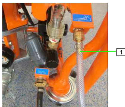
Figure 44 : Raccorder le tuyau d'air
