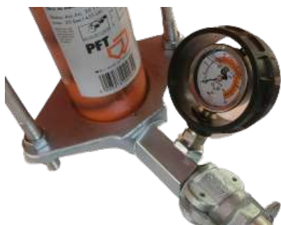
Figure 27 : Manomètre de pression du mortier
