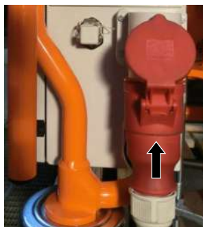
Figure 30 : Raccorder l'alimentation électrique
