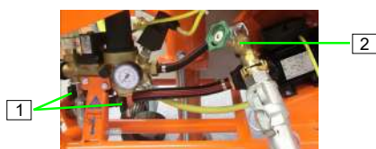
Figure 32 : Fermer les robinets de vidange
