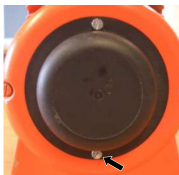
Figure 89 : Ouverture du couvercle du filtre
