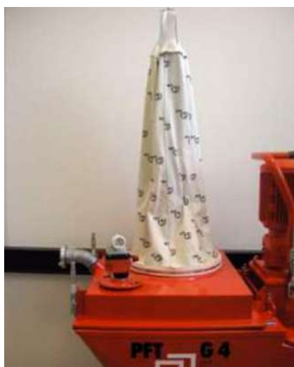
Figure 49 : Capot d'injection
