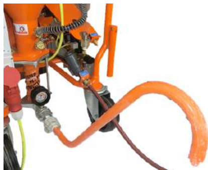
Figure 53 : Tube de contrôle de consistance
