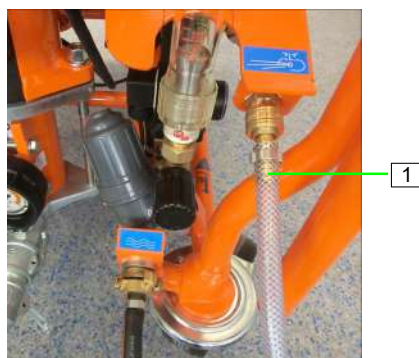
Figure 48 : Raccorder le tuyau d'air
