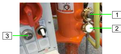
Figure 44 : Alimenter la zone de mélange en eau
