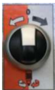
Figure 20 : Commutateur-sélecteur du moteur de la pompe
