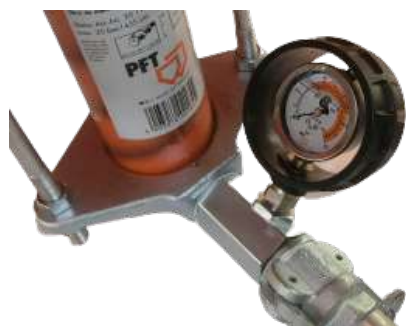
Figure 17 : Manomètre de pression du mortier
