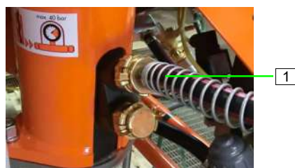
Figure 80 : Raccorder le tuyau d'eau
