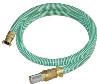
Figure 23 : Crépine avec tamis en inox, tuyau d'aspiration 1", 2,5 m
