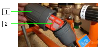
Figure 93 : Filtre en plastique
