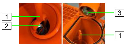
Figure 85 : Mise en place de l'arbre de malaxage
