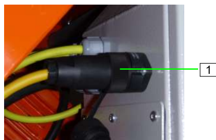
Figure 75 : Désactiver la sonde de niveau
