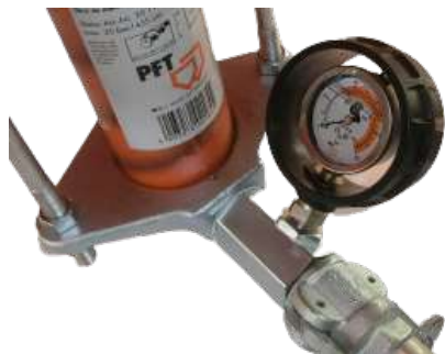
Figure 29 : Manomètre de pression du mortier
