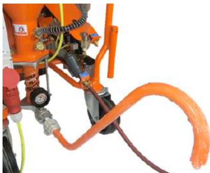
Figure 57 : Tube de contrôle de consistance
