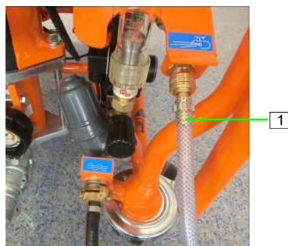
Figure 48 : Raccorder le tuyau d'air
