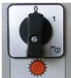
Figure 18 : Sélecteur du rotor alvéolaire
