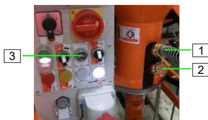
Figure 44 : Alimenter la zone de mélange en eau
