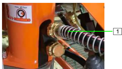
Figure 79 : Raccorder le tuyau d'eau
