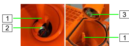
Figure 84 : Mise en place de l'arbre de malaxage
