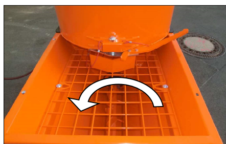
图 31: 检查旋转方向
