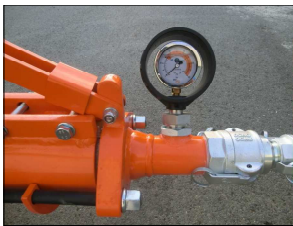
图 19: 砂浆压力计
