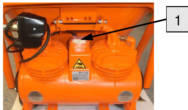
图 57: 空气压缩机
