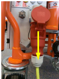
图 95: 取下连接电缆
