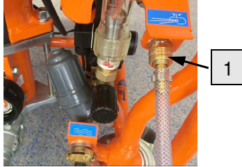
图 55: 连接空气软管
