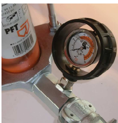
图 26：砂浆压力计
