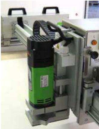
Fig. 15.01 Milling unit
