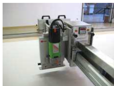
Fig. 11.03 Sawing unit, longitudinal, left
