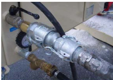
Abb. 62: Materialschläuche abkuppeln
