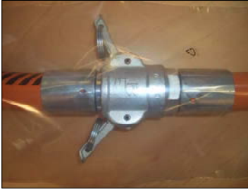
Abb. 57: Kupplung lösen
