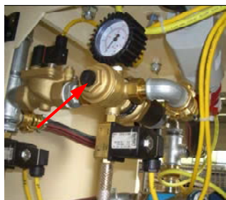
Abb. 84: Schmutzfängersieb Druckminderer
