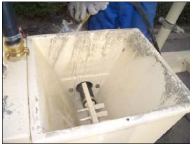
Abb. 68: Pumpenbehälter reinigen
