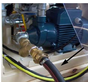
Abb. 58: Wasserschlauch abkuppeln
