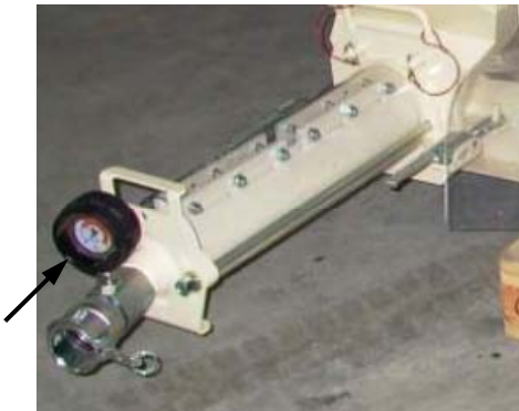
Abb. 22: Mörteldruckmanometer
