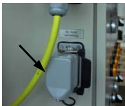
Abb. 19: Fernsteuerung anschließen
