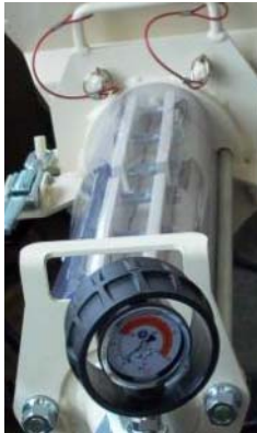
Abb. 60: Stator nachspannbar
