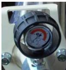
Abb. 43: Mörteldruckmanometer
