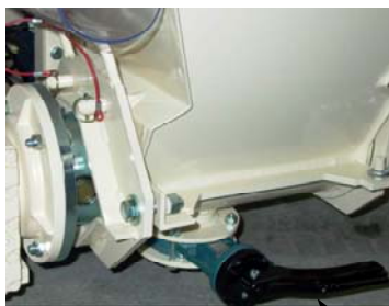
Abb. 56: Reinigungsstutzen
