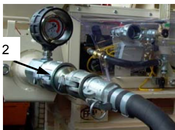
Abb. 32: Materialschlauch anschließen
