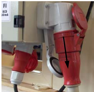
Abb. 59: Anschlusskabel entfernen
