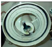
Abb. 53: Mischrohr reinigen
