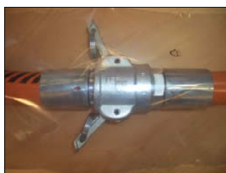
Abb. 46: Kupplung lösen
