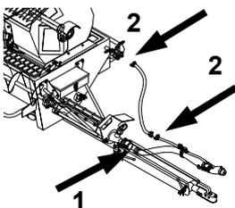
PFT Materialschlauch anschließen (1)
