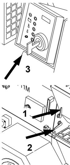
Den Mischbehälter und die Pumpe leerfahren, anschließend die Mischer und Pumpe am Hebel (1) und (2) ausschalten. Motor (3) ausschalten. Hahn am Feinputzgerät öffnen.
