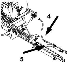
Spritzgerät und Luftschlauch (4) entfernen.
