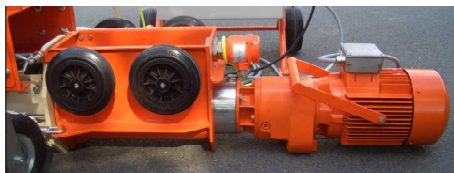
Abb. 17: Pumpeinheit abnehmen
