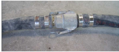
Abb. 60: Kupplung lösen
