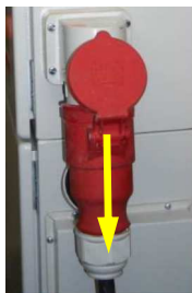
Abb. 82: Anschlusskabel entfernen
