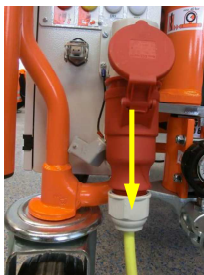
Abb. 5: Anschlusskabel entfernen
