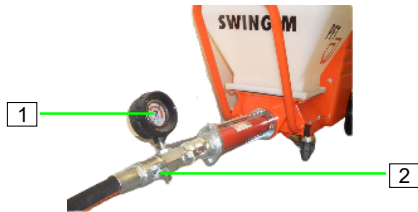
Abb. 10: Mörtelschlauch abkuppeln
