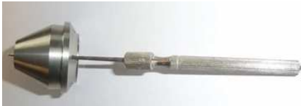
Abb. 15: Düse reinigen
