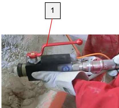
Abb. 9: Handhebel öffnen
