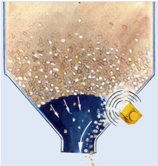
Auflösung einer Schüttgutbrücke im Silo
