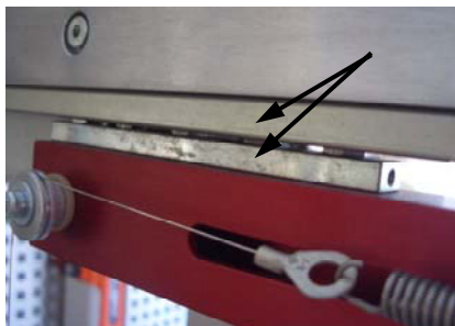
Abb. 1 Gleitschiene / Laufschiene
