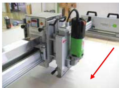
Bild 11.05 Sägeaggregat quer - rechts
