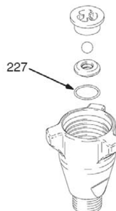
Abb. 4. Einlassventil auseinander bauen. Reinigen und überprüfen. Für den Ausbau des O-Rings (227) kann ein Haken erforderlich sein.
