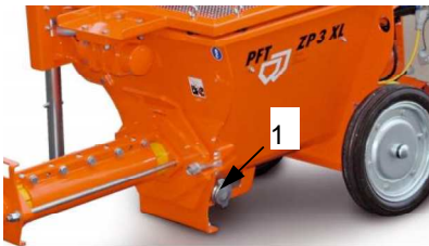
Abb. 48: Reinigungsdeckel öffnen
