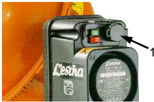
Abb. 26: Trommelmischer anschließen
