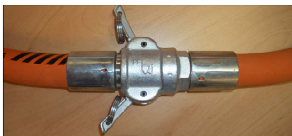
Abb. 50: Verbindungen lösen
