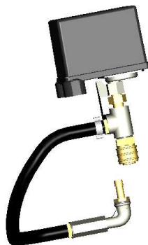
Abb. 12: Druckabschaltung Luftkompressor
