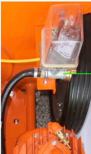
Abb. 32: Luftschlauch anschließen
