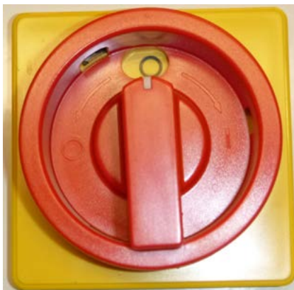
Abb. 48: Hauptschalter auf Stellung "0"
