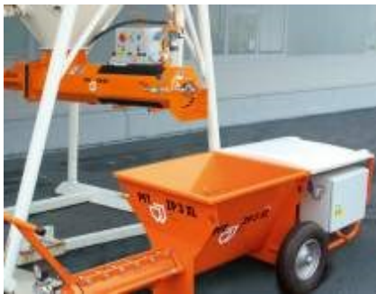
Abb. 31: ZP 3 mit Material beschicken
