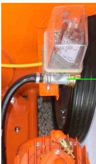
Abb. 29: Luftschlauch anschließen
