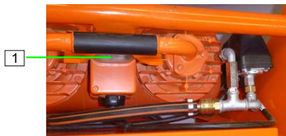
Abb. 42: Luftkompressor ausschalten
