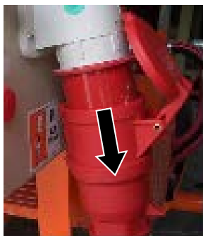
Abb. 60: Anschlusskabel entfernen
