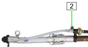
Abb. 38: Lufthahn öffnen
