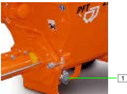
Abb. 24: Reinigungsstutzen öffnen
