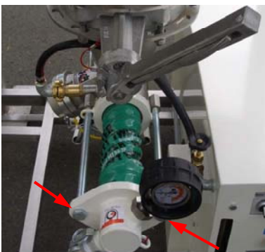
Abb. 54: Spannschrauben lösen
