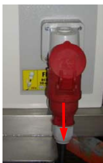
Abb. 59: Anschlusskabel entfernen
