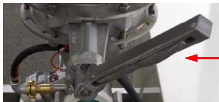
Abb. 48: Auslaufklappe schließen
