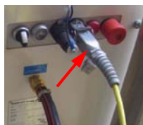
Abb. 26: Fernsteuerkabel einstecken
