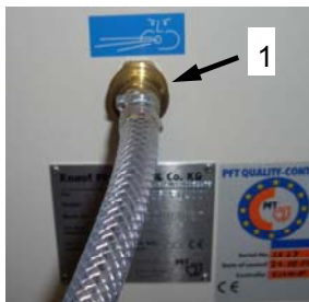
Abb. 21: Luftschlauch anschließen
