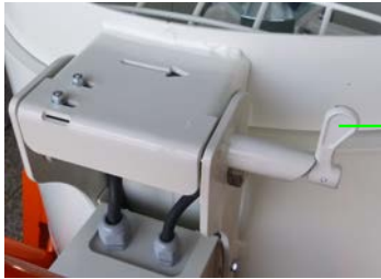
Abb. 32: Drehriegel schmieren
