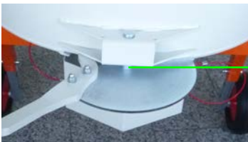
Abb. 30: Schieber reinigen
