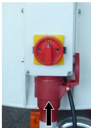
Abb. 15: Stromversorgung anschließen
