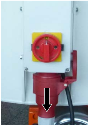
Abb. 31: Anschlusskabel entfernen
