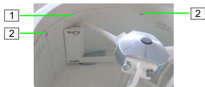
Abb. 36: Panzerblech austauschen
