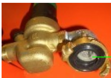
Abb. 23: Schmutzfängersieb prüfen
