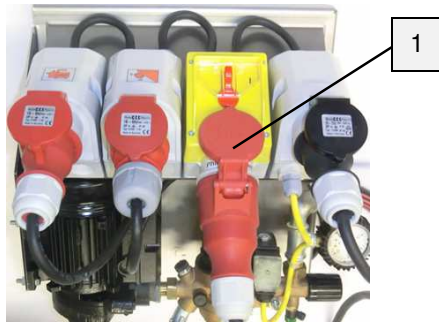
Abb. 13: Anschluss Strom
