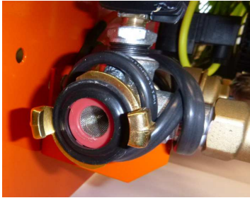
Abb. 56: Schmutzfängersieb im Wassereinlauf
