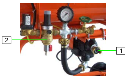
Abb. 24: Schmutzfängersiebe mit Druckerhöhungspumpe
