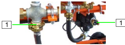
Abb. 52: Schmutzfängersieb im Wassereinlauf
