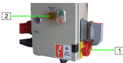
Abb. 22: Drehrichtung prüfen
