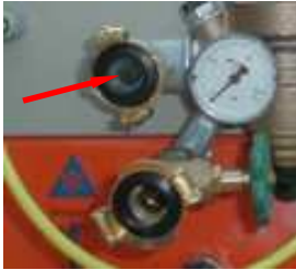
Abb. 49: Schmutzfängersieb im Wassereinlauf
