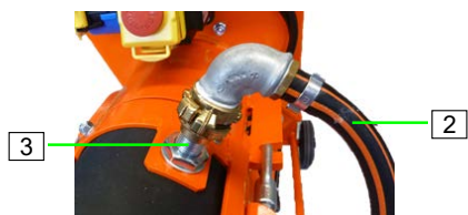
Abb. 26: Wasserschlauch anschließen
