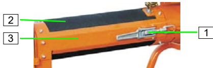
Abb. 41: Mischrohr reinigen
