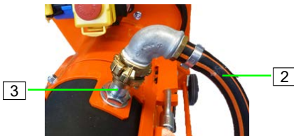
Abb. 36: Wasserzufuhr trennen
