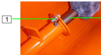
Abb. 44: Dosierwelle reinigen
