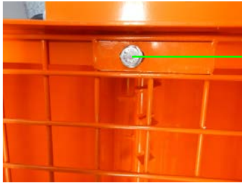
Abb. 43: Schutzgitter abnehmen
