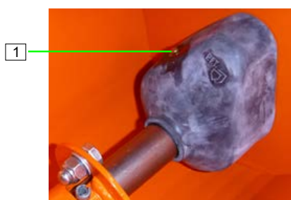
Abb. 48: Lager abschmieren
