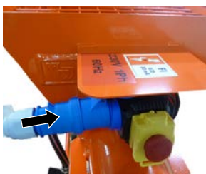
Abb. 17: Stromversorgung anschließen
