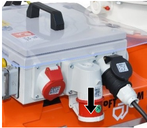
Abb. 45: Anschlusskabel entfernen
