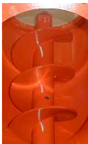
Abb. 7: Dosiermischwelle
