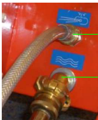
Abb. 70: Luftschlauch anschließen
