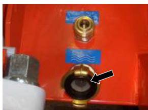
Abb. 96: Schmutzfängersieb im Wassereinlauf
