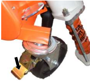
Abb. 26: Feststellrolle arretieren
