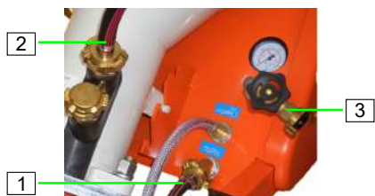
Abb. 67: Wasserzufuhr trennen
