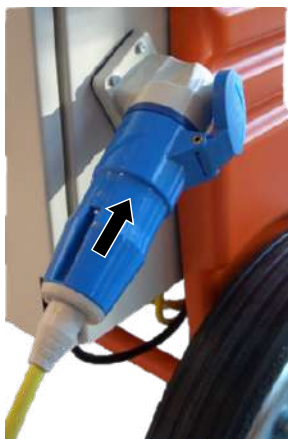
Abb. 30: Stromversorgung anschließen
