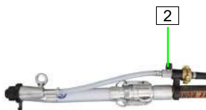
Abb. 58: Lufthahn öffnen
