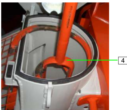
Abb. 77: Mischwendel entnehmen
