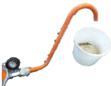
Abb. 53: Konsistenzprüfrohr
