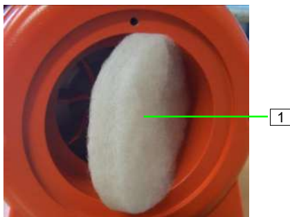
Abb. 94: Filter des Luftkompressors
