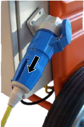
Abb. 92: Anschlusskabel entfernen
