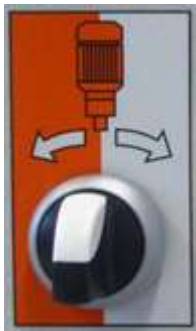
Abb. 19: Wahlschalter Pumpenmotor
