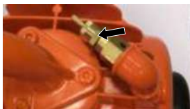
Abb. 101: Sicherheitsventil
