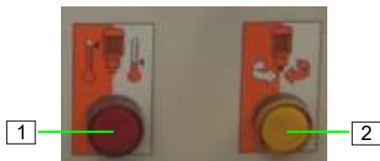
Abb. 85: Störungsanzeigen
