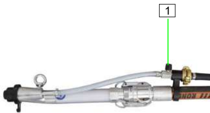
Abb. 59: Lufthahn schließen
