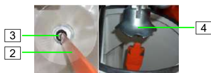
Abb. 79: Sitz der Reinigerwelle
