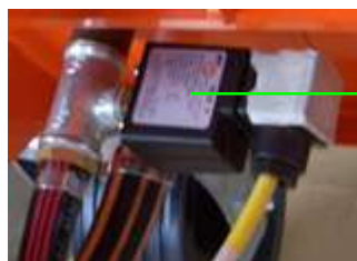
Abb. 99: Druckschalter Luft
