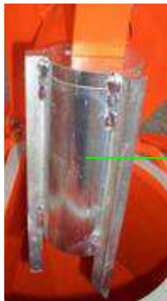
Abb. 78: Mischrohrreiniger einsetzen
