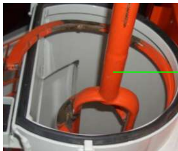
Abb. 68: Mischwendel entnehmen
