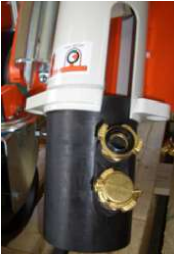
Abb. 83: Gummimischzone reinigen
