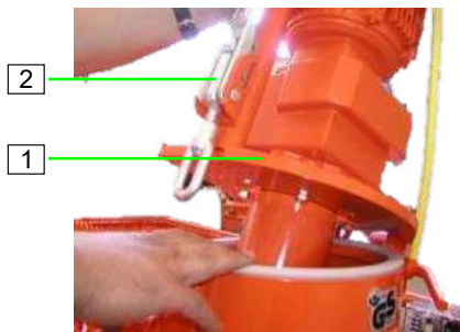
Abb. 80: Motorkippflansch schließen
