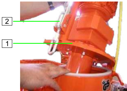
Abb. 5: Motorkippflansch schließen
