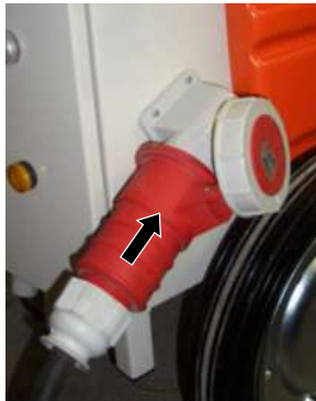
Abb. 32: Stromversorgung anschließen
