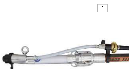
Abb. 62: Lufthahn schließen
