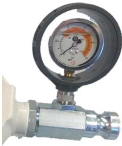
Abb. 16: Mörteldruckmanometer
