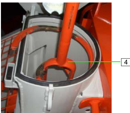
Abb. 79: Mischwendel entnehmen
