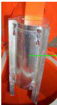
Abb. 80: Mischrohrreiniger einsetzen
