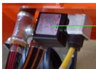
Abb. 97: Druckschalter Luft
