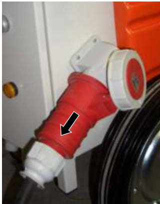
Abb. 92: Anschlusskabel entfernen
