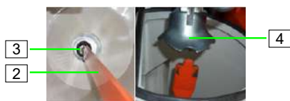
Abb. 81: Sitz der Reinigerwelle
