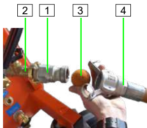
Abb. 75: Mörtelschlauch reinigen
