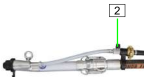
Abb. 60: Lufthahn öffnen
