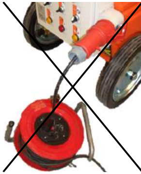
Abb. 31: Beispielbild für unzulässige Anschlussvariante
