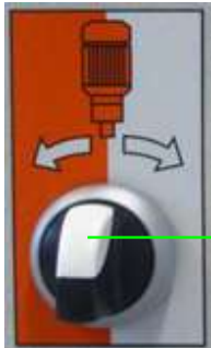
Abb. 63: Maschine ausschalten
