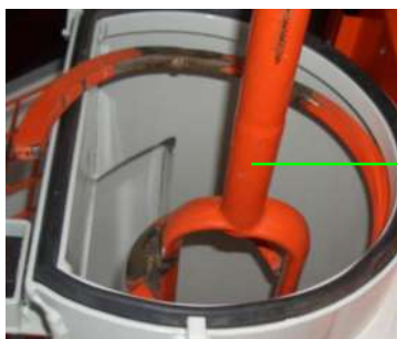
Abb. 70: Mischwendel entnehmen
