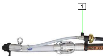
Abb. 61: Lufthahn schließen
