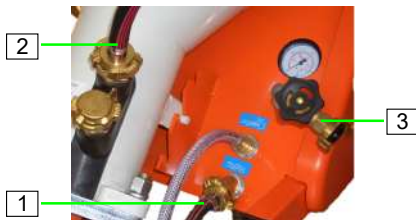
Abb. 69: Wasserzufuhr trennen
