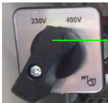
Abb. 21: Spannung wechseln
