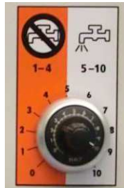
Abb. 13: Drehzahlregler
