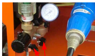
Abb. 21: Ablasshähne
