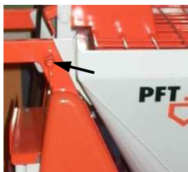
Abb. 15: Drehriegel öffnen
