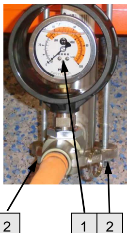
Abb. 61: Mörteldruck überprüfen
