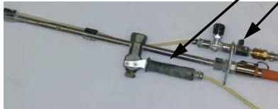
Abb. 44: Lufthahn öffnen
