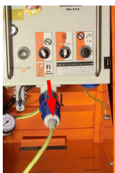
Abb. 83: Anschlusskabel entfernen
