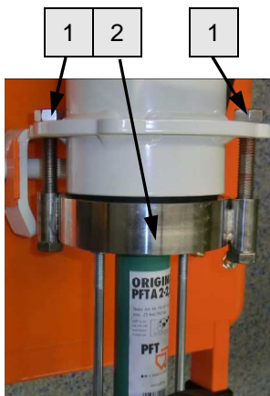
Abb. 76: Pumpe wechseln
