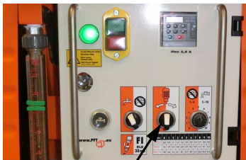
Abb. 64: Drehrichtung ändern
