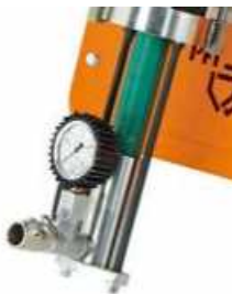
Abb. 14: Mörteldruckmanometer
