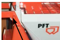
Abb. 31: Drehriegel öffnen
