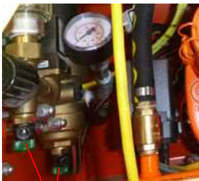
Abb. 106: Mischwendel entnehmen
