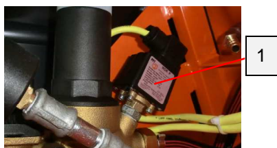
Abb. 115: Druckschalter
