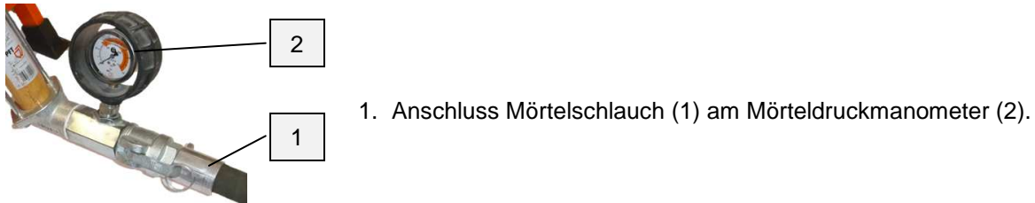
Abb. 16: Anschluss Mörtelschlauch
