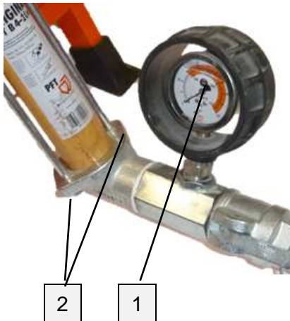
Abb. 75: Mörteldruck überprüfen
