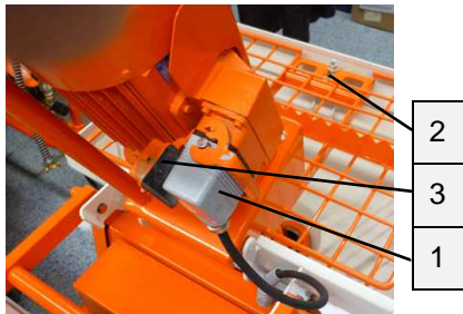
Abb. 91: Motorkippflansch öffnen
