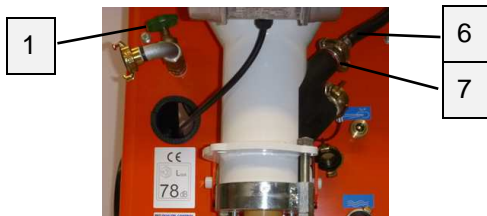
Abb. 42: Wasserentnahmeventil
