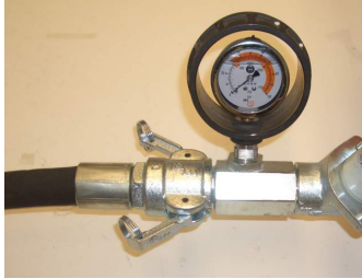
Abb. 78: Mörtdruck auf „0 bar“
