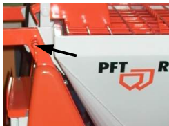
Abb. 25: Drehriegel öffnen
