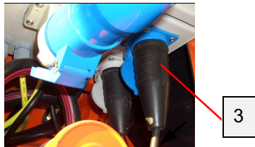
Abb. 71: Luftschlauch anschließen
