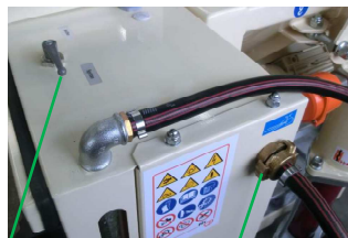
Abb. 51: Luftschauch anschließen
