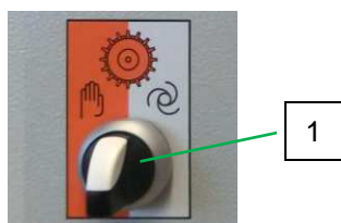
Abb. 76: Mischrohr leer fahren
