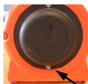
Abb. 91: Öffnung Filterabdeckung
