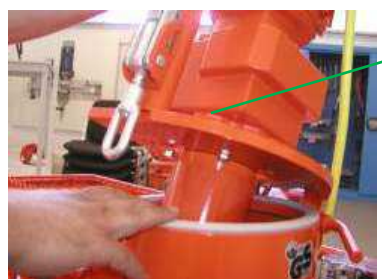
Abb. 79: Motorkippflansch schließen
