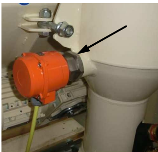
Abb. 26: Füllstandsonde im Mischrohr
