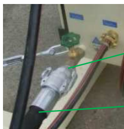
Abb. 49: Mörtelschlauch vorbereiten
