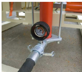
Abb. 16: Mörteldruckmanometer
