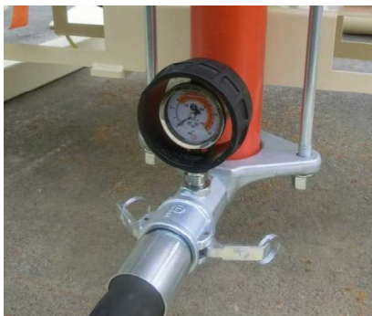
Abb. 41: Mörteldruckmanometer
