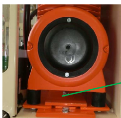
Abb. 92: Luftkompressor heraus ziehen
