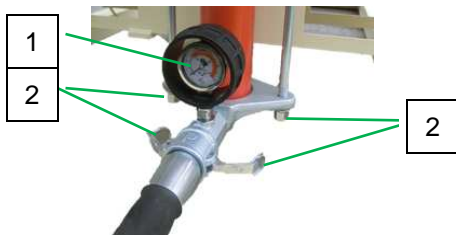
Abb. 67: Mörteldruckmanometer
