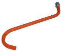
Abb. 46: Konsistenzprüfrohr
