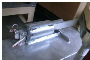
Abb. 78: Mischrohr-reiniger
