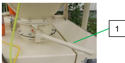
Abb. 43: Siloklappe öffnen
