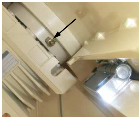
Abb. 99: Getriebemotor abschmieren
