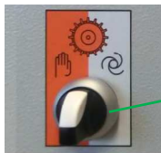
Abb. 68: Mischrohr leer fahren
