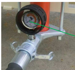
Abb. 73: Mörteldruck auf „0 bar“
