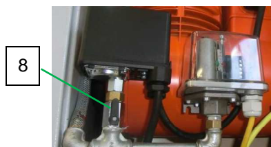
Abb. 61: Kugelhahn Druckabschaltung
