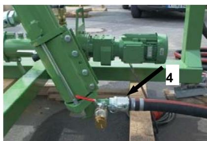
Förderschlauch (4) von Getreidepumpe zum Nachfermenter anschließen.
