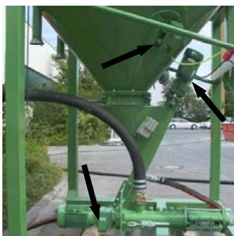
Beide Motoranschlusskabel mit dem Schaltschrank (bauseitig) verbinden.
