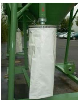
Entstaubungsfilter 1x wöchentlich, oder nach Bedarf reinigen!
