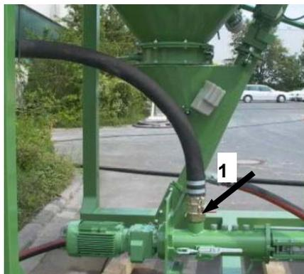
Saugschlauch für Gülle an Güllepumpe (1) anschließen.
