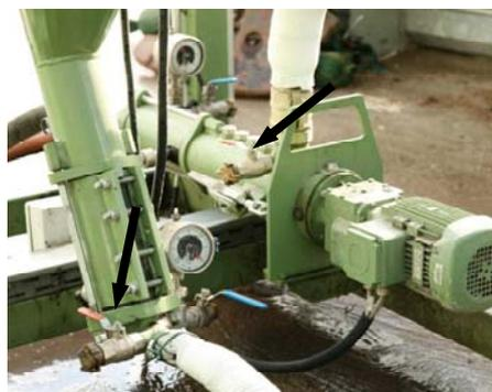
Kugelhahn an der Güllepumpe und an der Getreidemischpumpe schließen.
