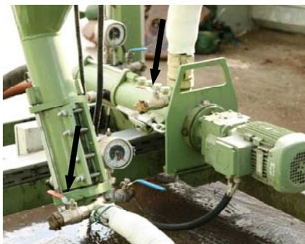
Druckentlastung durch öffnen der Kugelhähne.
