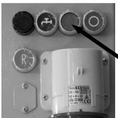
Grünen Drucktaster „Betrieb Ein“ drücken und Lufthahn am Spritzgerät öffnen. Die Maschine läuft nun an; mit dem Putzen kann begonnen werden. Zunächst fließt am Spritzgerät dünnes Material aus, danach tritt der Mörtel in der richtigen Konsistenz aus. Es kann auch mit Hilfe des Nadelventils nachreguliert werden.
