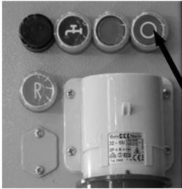
Roten Drucktaster „Betrieb AUS“ betätigen (Maschine bleibt stehen).
