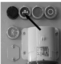
Wasservorlauftaste drücken. Das Wasser wird nun mit Druckluft aus der Armatur geblasen! (bei 1,5bar ca. 1 Minute lang)
