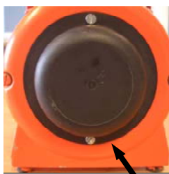
Abb. 61: Öffnung Filterabdeckung
