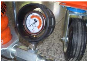
Abb. 55: Mörteldruckmanometer
