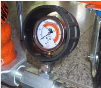
Abb. 58: Mörteldruck auf „0 bar“
