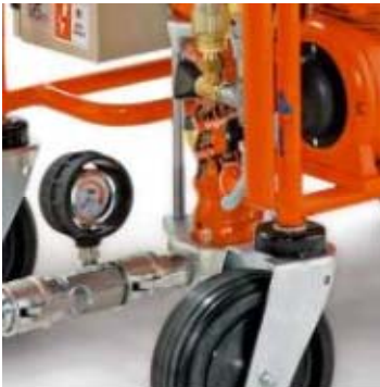
Abb. 21: Mörteldruckmanometer
