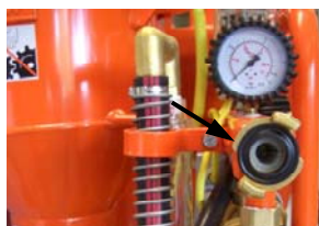
Abb. 62: Messingsieb im Wassereinlauf
