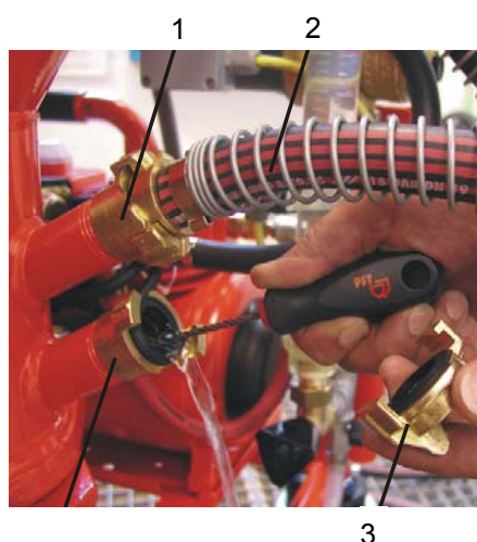
Abb. 20: Blinddeckel und Wasserstutzen
