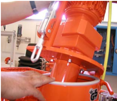
Abb. 39: Motorkippflansch schließen
