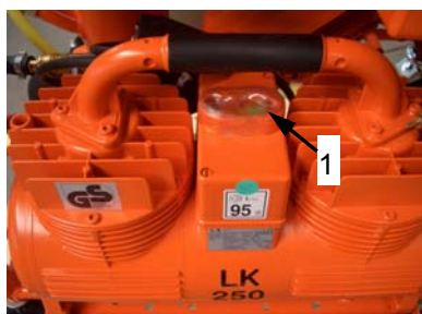
Abb. 32: Kompressor einschalten
