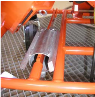
Abb. 38: Mischrohrreiniger einsetzen
