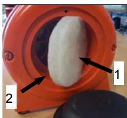
Abb. 60: Filter des Kompressors
