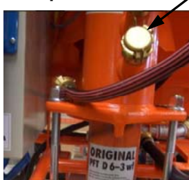
Abb. 42: Blindeckel am Wasserstutzen
