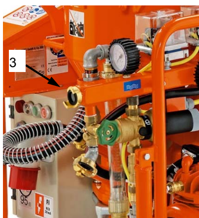
Abb. 18: Wasser anschließen
