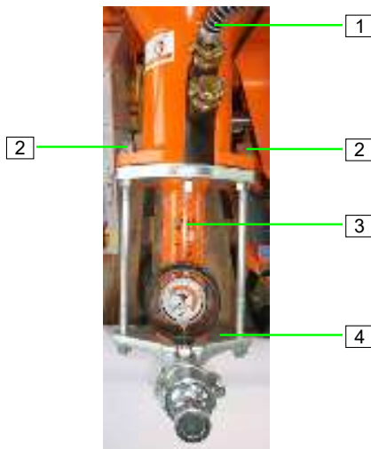
Abb. 86: Pumpeneinheit abnehmen
