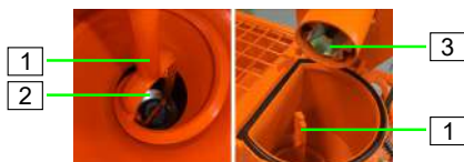
Abb. 84: Mischwendel einsetzen
