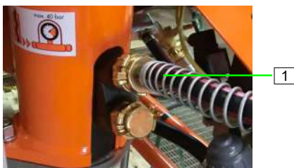
Abb. 79: Wasserschlauch anschließen
