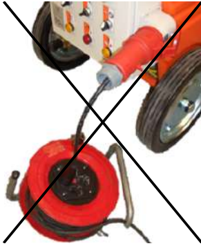
Abb. 33: Beispielbild für unzulässige Anschlussvariante
