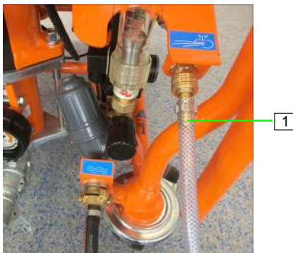
Abb. 48: Luftschlauch anschließen
