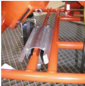
Abb. 49: Mischrohrreiniger einsetzen
