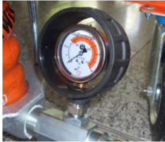
Abb. 69: Mörtdruck auf „0“ bar
