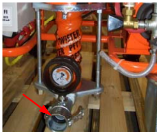
Abb. 54: Ablagerung Druckflansch
