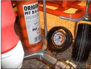
Abb. 28: Mörteldruckmanometer
