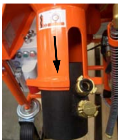
Abb. 56: Gummimischzone reinigen
