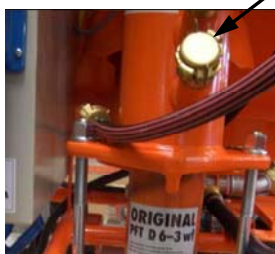
Abb. 52: Blindeckel am Wasserstutzen
