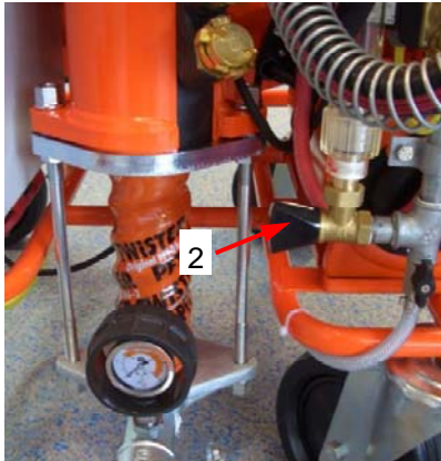
Abb. 34: Nadelventil
