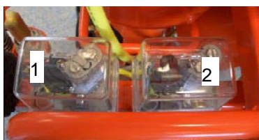
Abb. 77: Lage der Druckschalter
