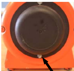
Abb. 73: Öffnung Filterabdeckung
