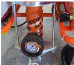
Abb. 66: Mörteldruckmanometer
