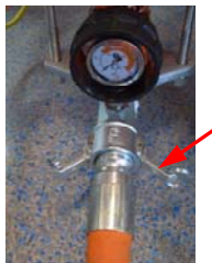
Abb. 45: Mörtelschlauch abnehmen
