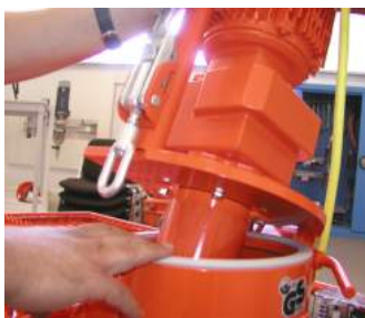
Abb. 50: Motorkippflansch schließen
