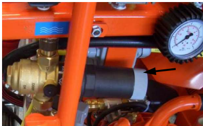
Abb. 76: Druckminderventil
