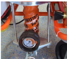
Abb. 66: Mörteldruckmanometer
