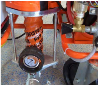
Abb. 30: Mörteldruckmanometer
