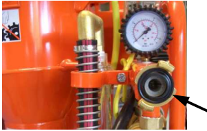
Abb. 74: Messingsieb im Wassereinlauf
