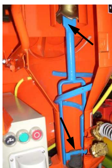
Abb. 58: Motorkippflansch schließen
