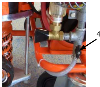
Abb. 61: Ablasshahn öffnen
