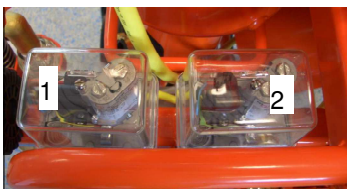
Abb. 77: Lage der Druckschalter
