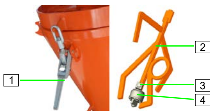
Abb. 49: Freilauf abschmieren
