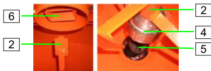
Abb. 50: Rührwerk einsetzen
