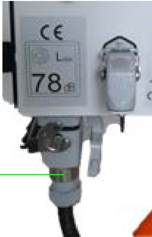
Abb. 21: Motoranschlusskabel anschließen
