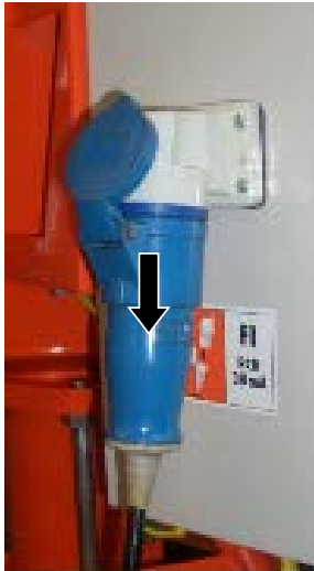
Abb. 48: Anschlusskabel entfernen
