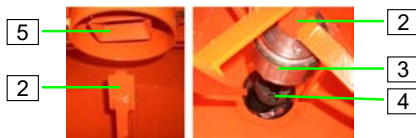
Abb. 41: Rührwerk reinigen
