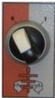
Abb. 15: Wahlschalter Mischvorgang
