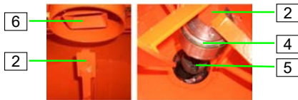
Abb. 51: Rührwerk einsetzen
