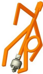
Abb. 10: Baugruppe Rührwerk
