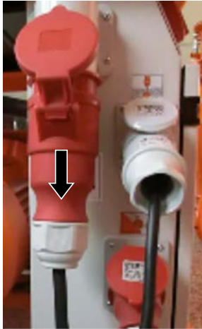
Abb. 46: Stromzufuhr unterbrechen
