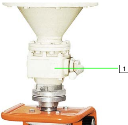
Abb. 41: Siloeslaufklappe schließen
