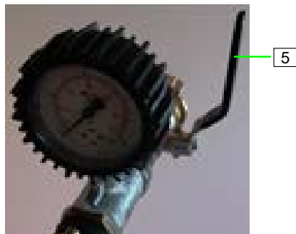
Abb. 22: Absperrhahn schließen
