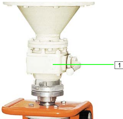
Abb. 36: Siloauslaufklappe schließen
