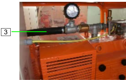
Abb. 21: Luftschlauch anschließen
