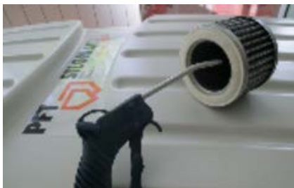
Abb. 63: Filterpatronen reinigen
