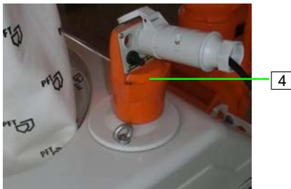
Abb. 17: Steuerkabel anschließen
