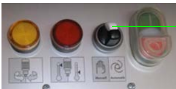
Abb. 44: Förderschläuche freiblasen
