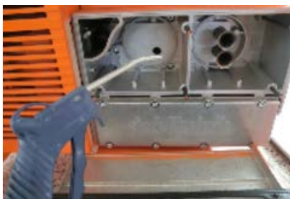
Abb. 64: Filtergehäuse reinigen
