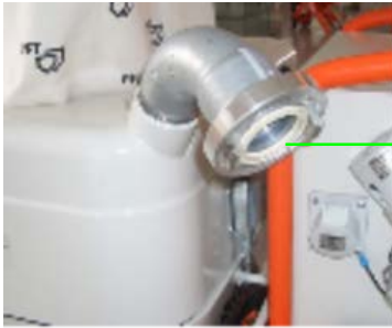
Abb. 19: Förderschlauch anschließen
