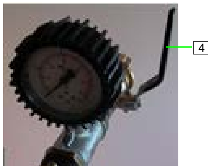
Abb. 27: Absperrhahn öffnen
