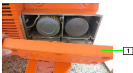
Abb. 61: Filterdeckel lösen
