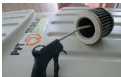
Abb. 63: Filterpatronen reinigen
