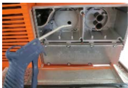
Abb. 64: Filtergehäuse reinigen
