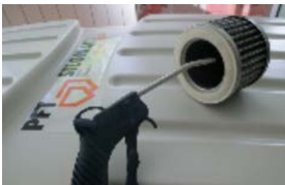
Abb. 51: Filterpatronen reinigen
