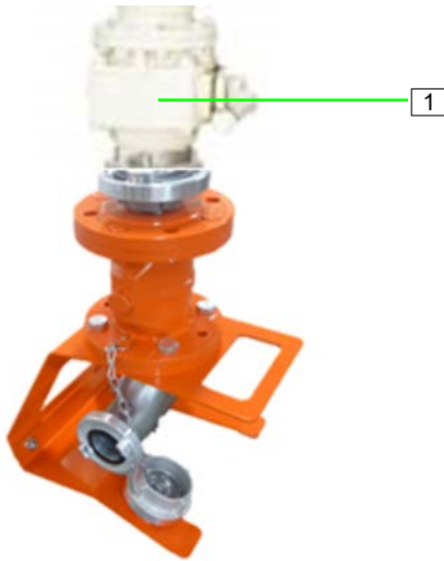
Abb. 16: Förderblock anschließen
