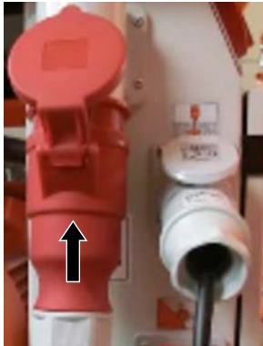
Abb. 13: Stromversorgung anschließen
