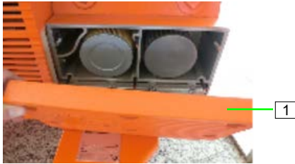
Abb. 49: Filterdeckel lösen
