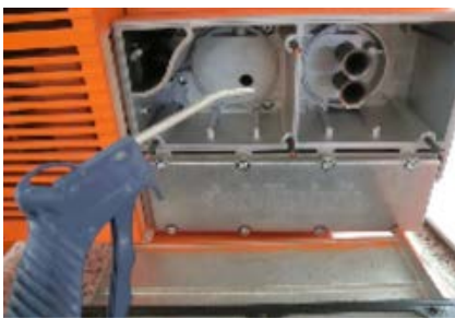
Abb. 52: Filtergehäuse reinigen
