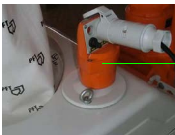
Abb. 15: Steuerkabel anschließen
