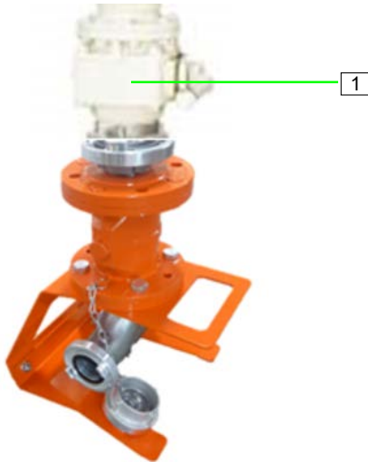
Abb. 21: Siloauslaufklappe öffnen
