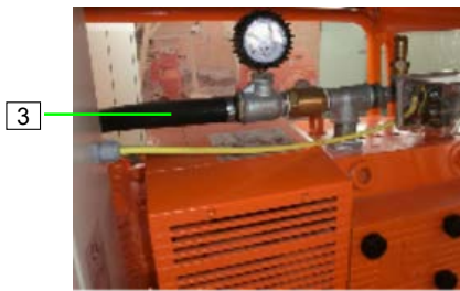
Abb. 19: Luftschlauch anschließen
