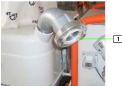
Abb. 17: Förderschlauch anschließen
